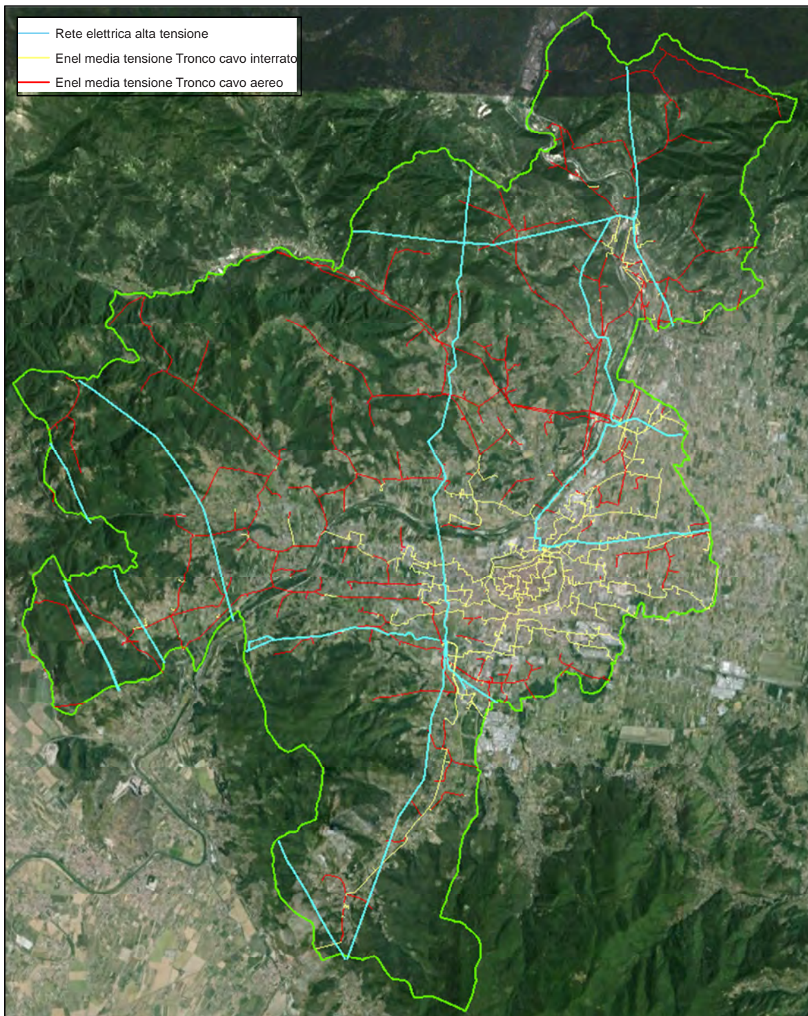
Figura 10. Reti tecnologiche: Rete elettrica
