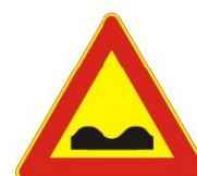
Figura II 389 Art. 31 STRADA DEFORMATA
